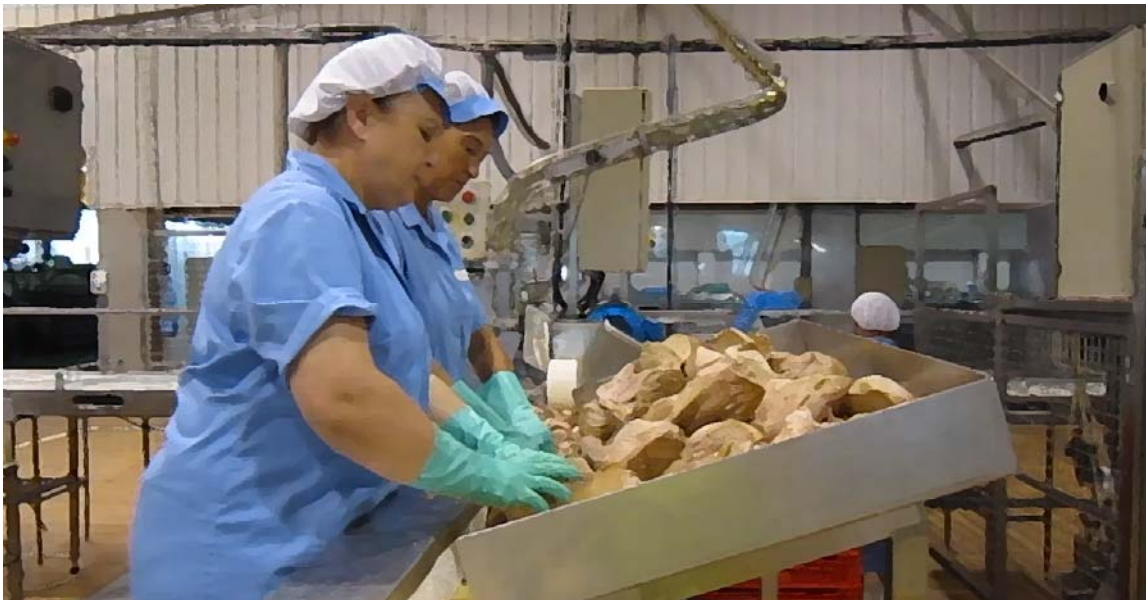
Figura 2.3. Un dos maiores riscos de TME no sector da conserva de atún resultan ser os movementos repetitivos de precisión, como é o caso do posto de empaque de atún.
