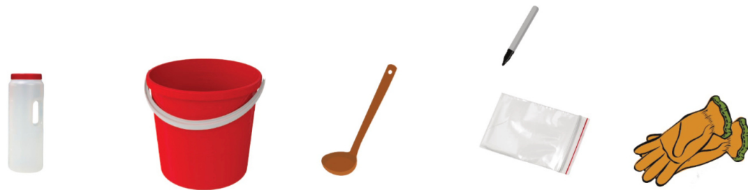
Figura 3. Material básico, xunto co tomamostras de columna, preciso para a toma de mostras de xurro.
