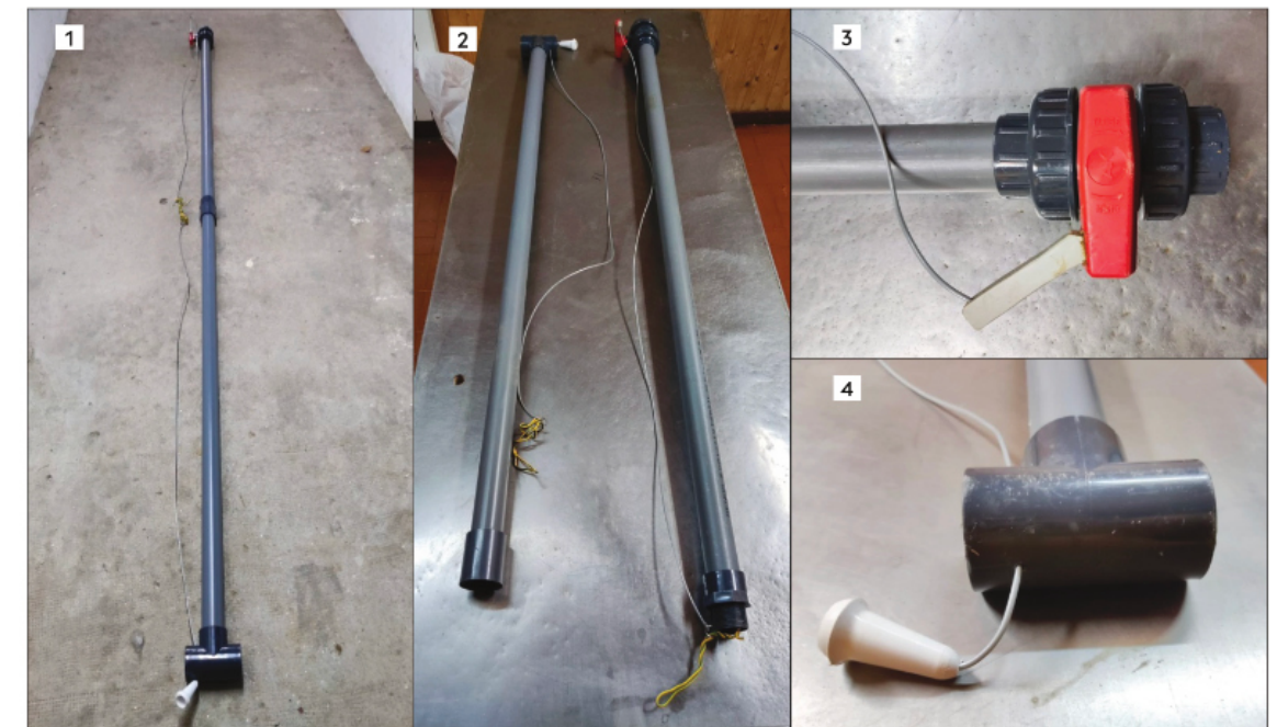
Figura 4: Detalles dun tomamostras de columna. 1) Tomamostras montado de 3 m de longo. 2) Tomamostras desmontado en 2 tramos. 3) Válvula de peche. 4) Tirador de accionamento da válvula.
