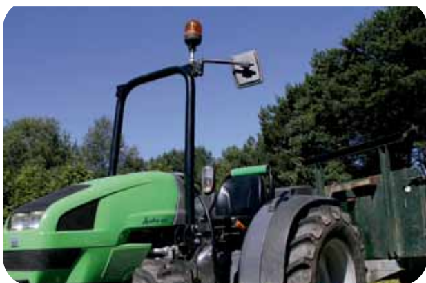
Sinalización luminosa V-2: Xirafaro
