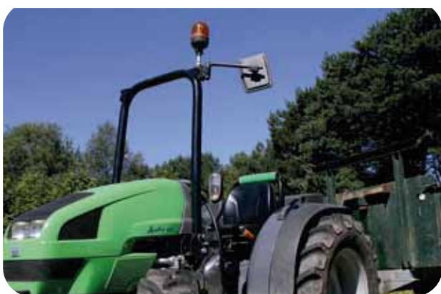
Señalización luminosa V-2: Girafaro
