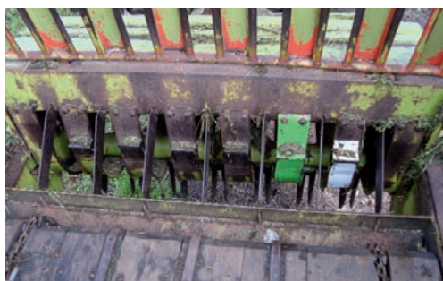
Parte do autocargador que quedou atascada coa herba e na que se produciu o accidente.
