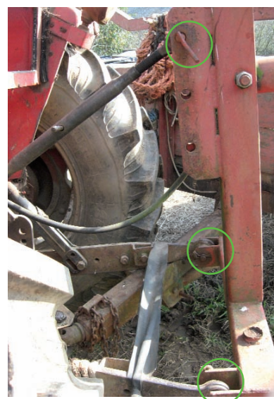
Puntos de enganche do apeiro no tractor.
