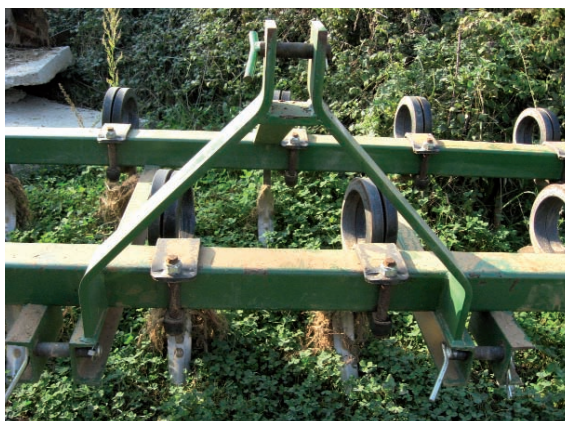
Tres puntos de enganche co tractor.
