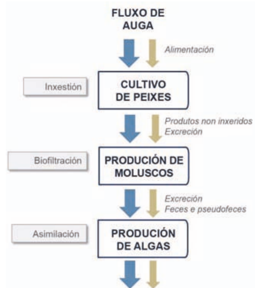
Figura 4. Esquema dun exemplo de sistema de Acuicultura multitrófica Integrada
