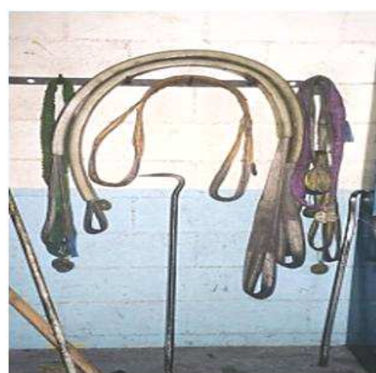
Accesorios colocados en soportes en zonas ventiladas
