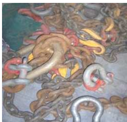
Accesorios almacenados de forma defectuosa
