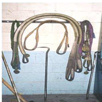
Accesorios colocados en soportes en zonas ventiladas
