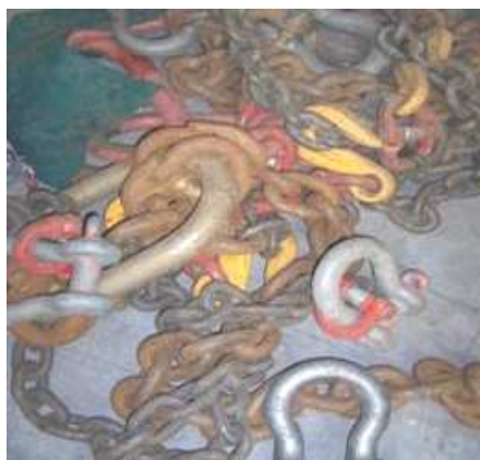
Accesorios almacenados de forma defectuosa
