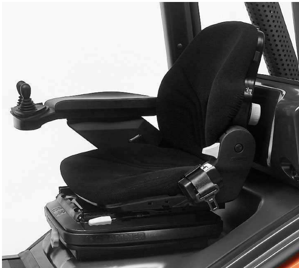
Imagen 3. Asiento de carretilla equipado con cinturón de seguridad
