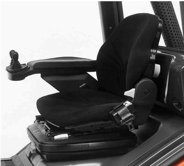
Imaxe 3. Asento de carretilla equipado con cinto de seguridade
