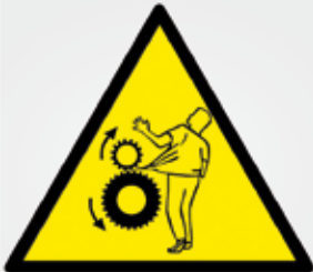
Risco de atrapamento
