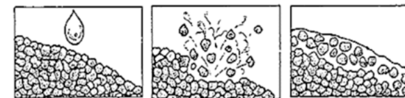
Figura 2. Representación de erosión por salpicadura
