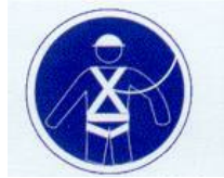
Protección individual obrigada contra caídas
