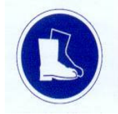
Protección obrigada dos pés
