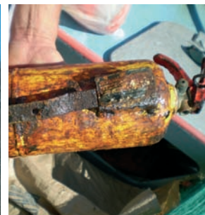
Deficiencia: extintor en mal estado
