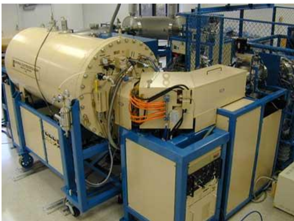
Figura 2.18. Acelerador de espectrómetro de masas Pelletron, modelo 1.5 SDH-1, utilizado para datacións por ^{14}\text{C} .
