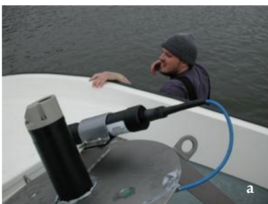
Figura 2.21. Correntímetros utilizados para os fondeos a) interno e b) externo.
