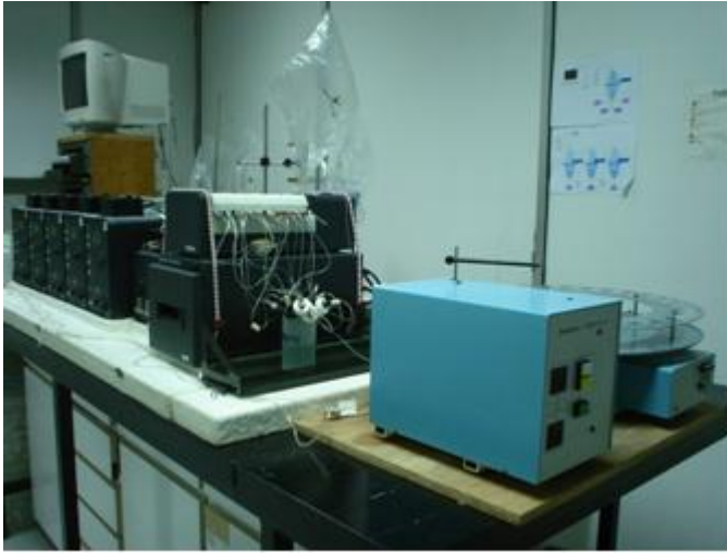
Figura 2.11. Sistema de análise dos sales nutrientes por métodos en fluxo continuo segmentado.
