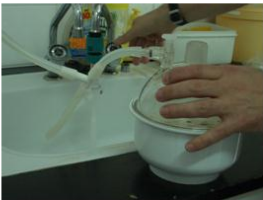
Figura 2.08. Desecador de baleiro empregado para secar os filtros de materia particulada antes de conxelalos a -20^{\circ}\text{C} .
