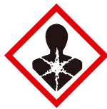
Puede provocar daños importantes a la salud
