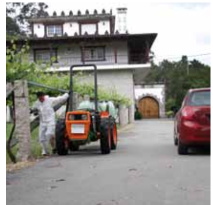
Baja del tractor por el lado opuesto al que circulan el resto de vehículos.
