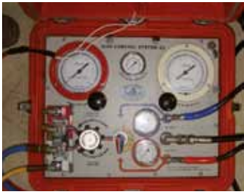
Cadro de distribución de gases + comunicación
