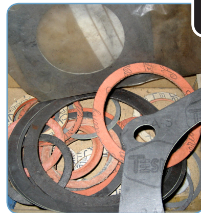
Juntas de cartón- amianto
