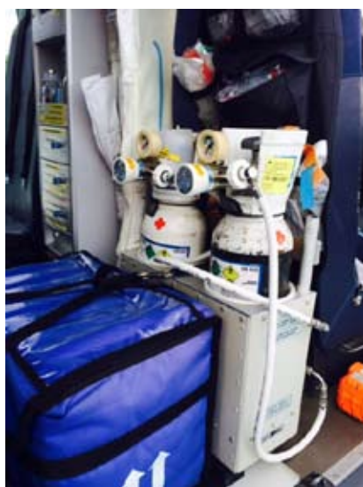
Osíxeno medicinal. Dúas balas detrás do asento do comandante, lado da dereita da aeronave, e outra no lateral do lado esquerdo, portátil
