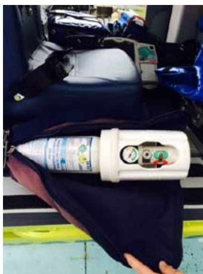
Osíxeno medicinal. Dúas balas detrás do asento do comandante, lado da dereita da aeronave, e outra no lateral do lado esquerdo, portátil
