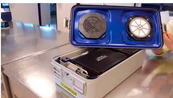
Fig. 1. Contenedor rígido con filtros reutilizables. Fig. 2. Contenedor rígido con filtros desechables.
