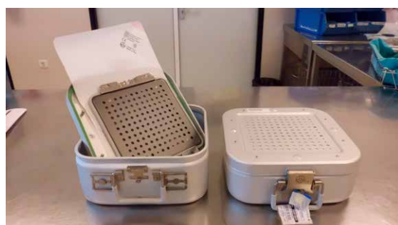
Fig. 1. Contenedor rígido con filtros reutilizables. Fig. 2. Contenedor rígido con filtros desechables.
