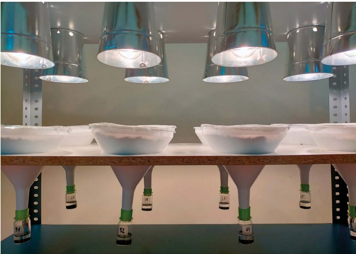
Extractor de microartrópodos: as lámpadas proporcionan luz e calor ás mostras do solo situadas dentro dos funís, o cal provoca que os invertebrados queiran escapar e caian nos botes
